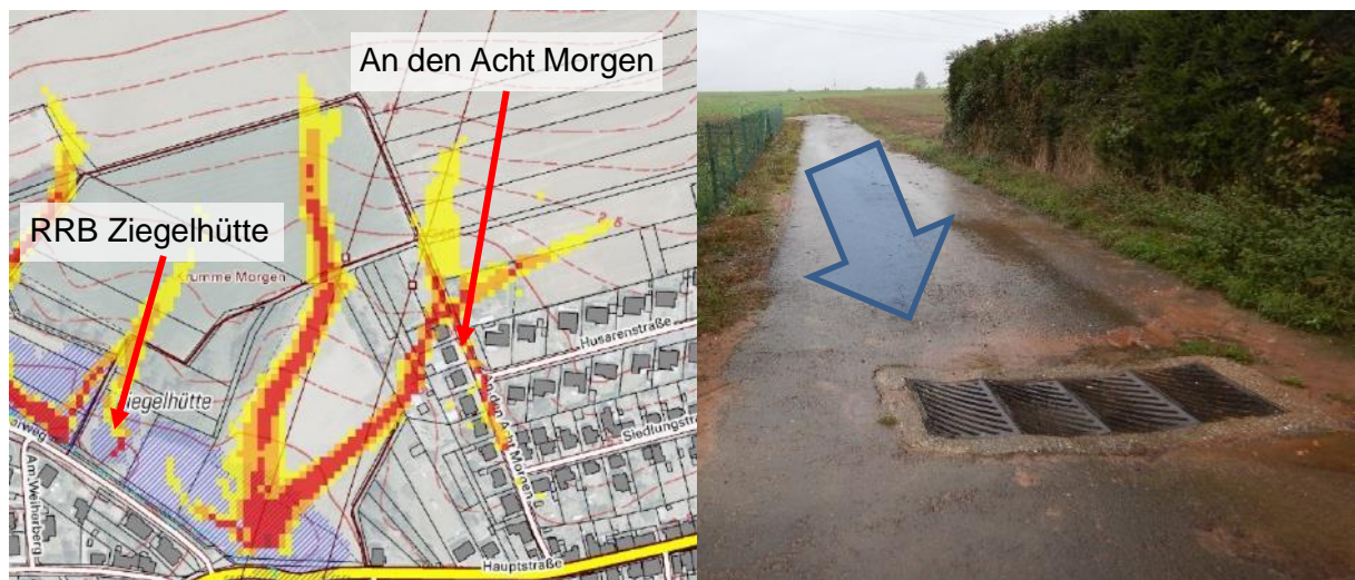
Abbildung 26 Starkregenzufluss An den Acht Morgen, Straßenablauf zum RRB Ziegelhütte
