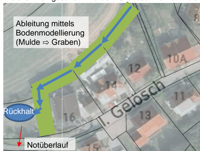
Abbildung 33 Ableitung Oberflächenzufluss „Im Gelösch“
