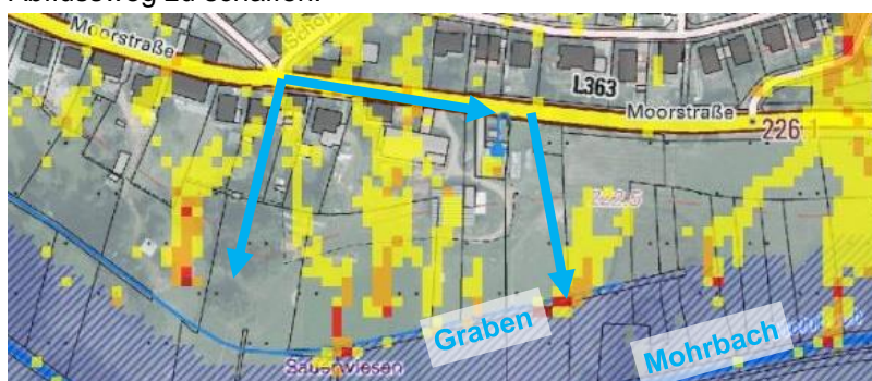
Abbildung 39 Mögliche Notabflusswege von der Moorstraße
